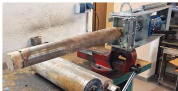
Der Bohrkerntrieb im Schraubstock für das Lösen schmaler Bohrkronen.
