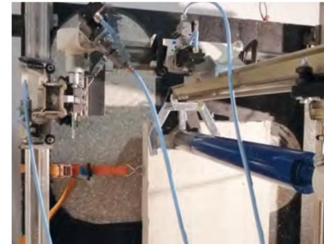
Erfolgreiche Stichbohrung; im Hintergrund ist die Frässpur erkennbar.
