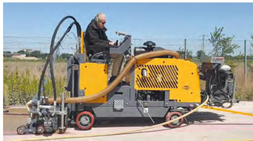
Cedima-Fugenschneider mit 800-mm-Grinding-Anbausatz.
