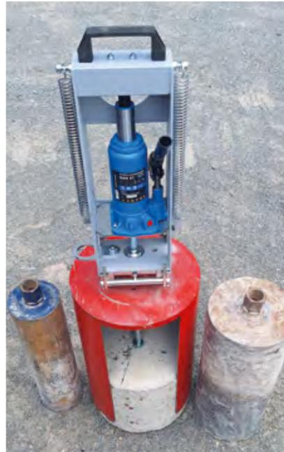
Hydraulischer Bohrkerntrieb BKT 5t.
