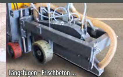
Längsfugen - Frischbeton ...
