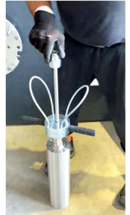
Der K50-Core-Pusher mit Hammeraufsatz.
