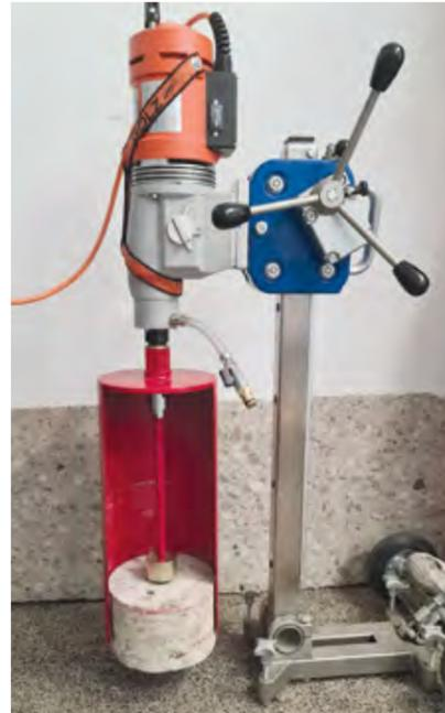
Der montierte Bohrkernfänger in einer symbolischen Schnittansicht.
