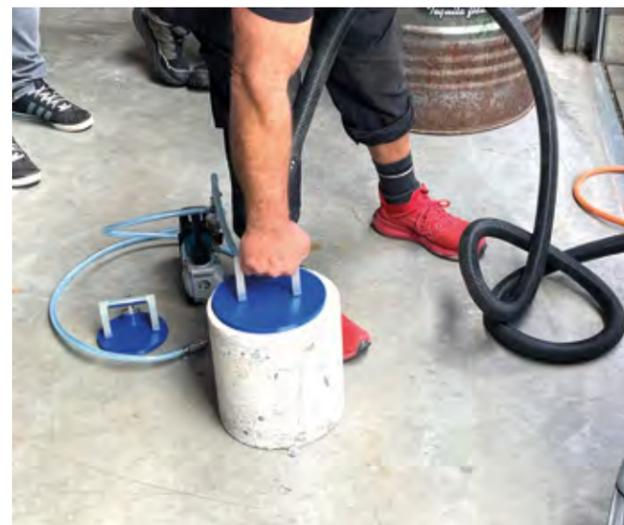
Der Kernheber – Kraft durch Vakuum.
